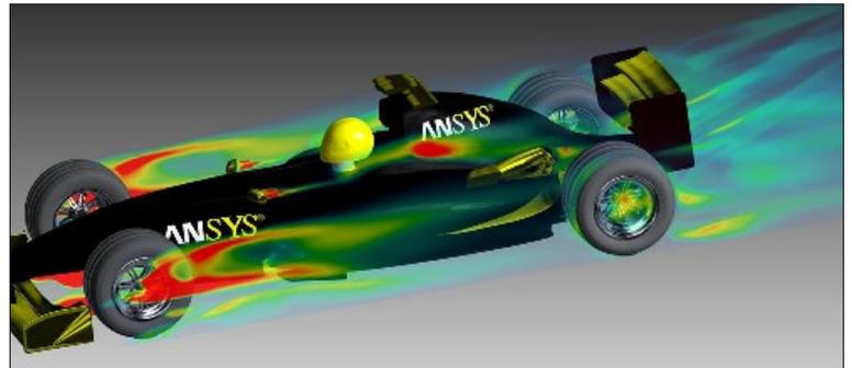
Peut-on simuler ça ? Et bien oui ! Le modèle à mettre en place est dit **multi-physique** car il fait intervenir différents domaines des sciences physiques (mécanique du solide, des fluides, thermique).
